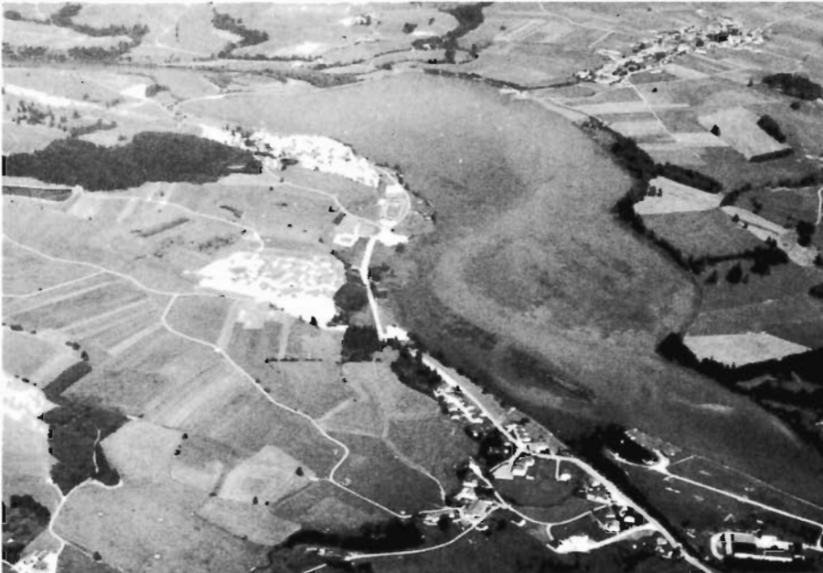
Abb. 2: Mittleres Lechtal bei Lechbruck (Stauseufe 3, 1981) So wie hier wurde fast der gesamte Bayerische Lech in eine Stauseen- kette verwandelt. Die ehemals brei- ten Umlagerungsstrecken sind noch im Stausee erkennbar. Foto: E. Eberhardinger; Luftbild- freigabe LA Südbayern G 26 183. Abdruck mit freundlicher Geneh- migung der BAWAG
